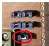
Lors des essais, on pourra essayer de réduire la durée de commandes des aiguillages, en vérifiant que leur fonctionnement soit toujours franc. Le changement de position des cavaliers est pris en compte par le 16F628A, sans avoir besoin de remettre le montage sous tension.
