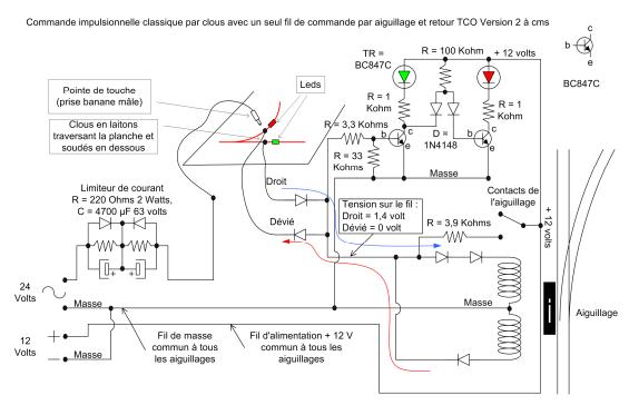
Commande impulsionnelle classique par clous avec un seul fil de commande par aiguillage et retour TCO Les transistors forment un interrupteur fermé "(c)-(e)", si la tension sur leur base (b) est > 0,7 volt Version 2 à cms
