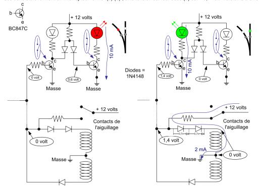
Le schéma pour un aiguillage triple PECO.
