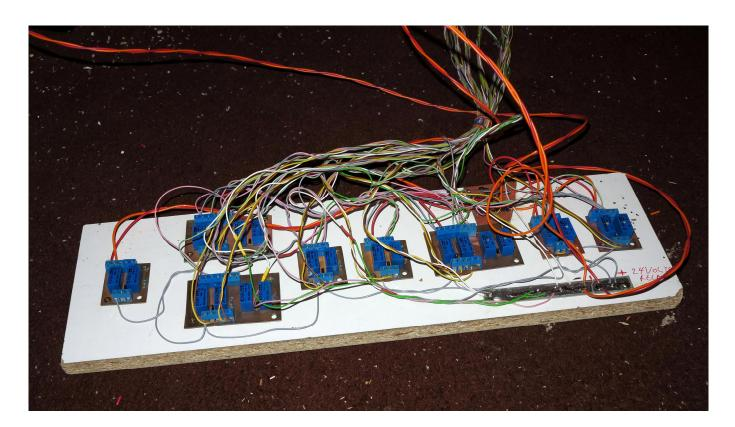
On peut utiliser des relais 12 volts ou 24 volts.
