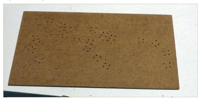
On reperce l'emplacement des leds avec un foret de 5 mm. On peint le tout en noir. On met en force les leds et l'on bouche les trous avec de la pâte à bois.
