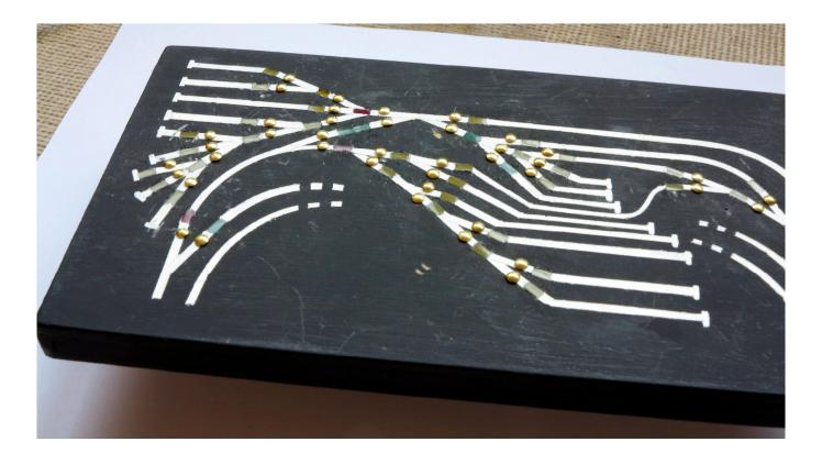
Pour câbler le TCO, il faut savoir quelle tension (-) ou (+) commande les aiguillages, pour déterminer quel clou va sur la diode du circuit imprimé.
