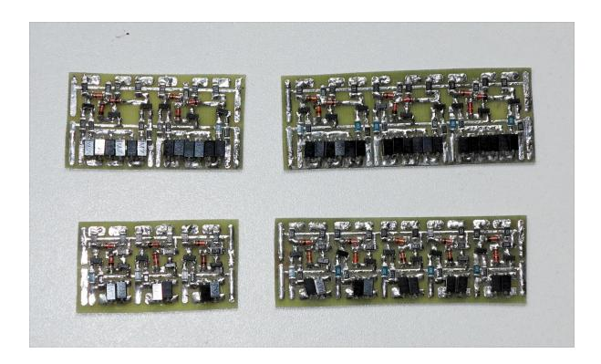
Bien nettoyer le circuit imprimé avec de l'acétone ou de l'alcool à bruler. Ne pas laisser de reste de flux de soudure entre piste. Si nécessaire, passer un coup de tournevis hors tension, en deux pistes du circuit.
