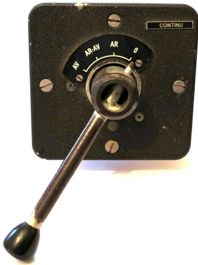
La clé de sélection des pantographes, permet de choisir quatre positions pour les pantographes. On peut avoir les deux pantographes baissés, l'arrière levé, les deux levés ou l'avant levé.
