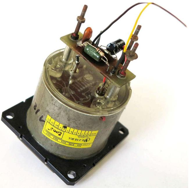
On soude une diode 1N4007 en bout du fil jaune, sur le circuit imprimé.
