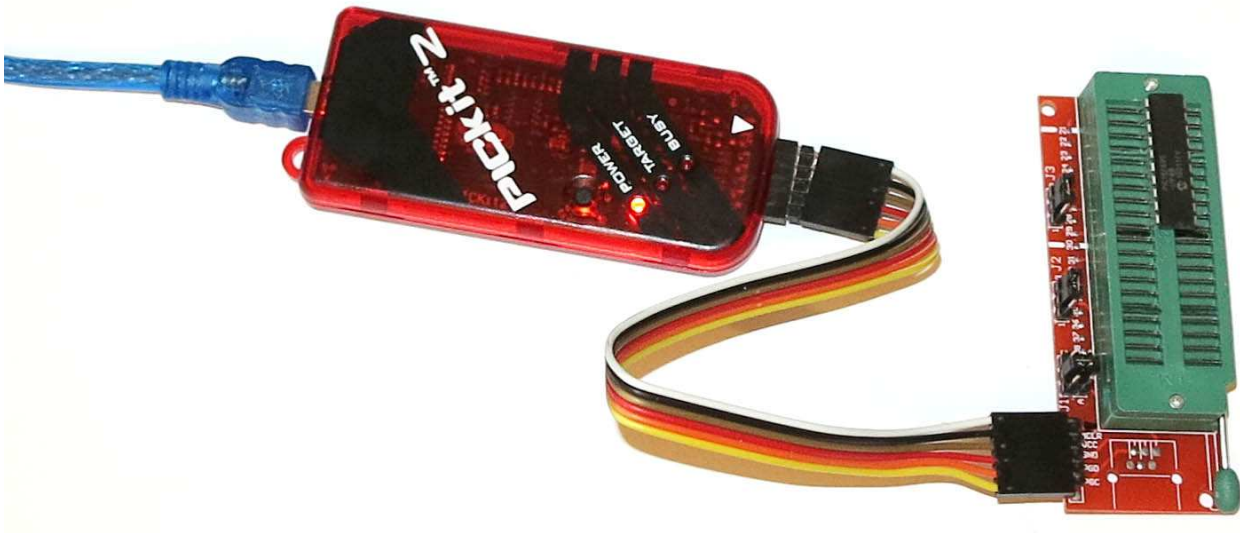
Suivre la couleur du câble pour cette broche n°1 et connecter la nappe avec ce fil en face de la broche 'vpp/MCLR' du circuit imprimé.
