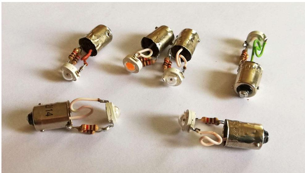
On protège les connexions d'un risque de court-circuit avec le boîtier métallique, avec de la gaine thermo rétractable.
